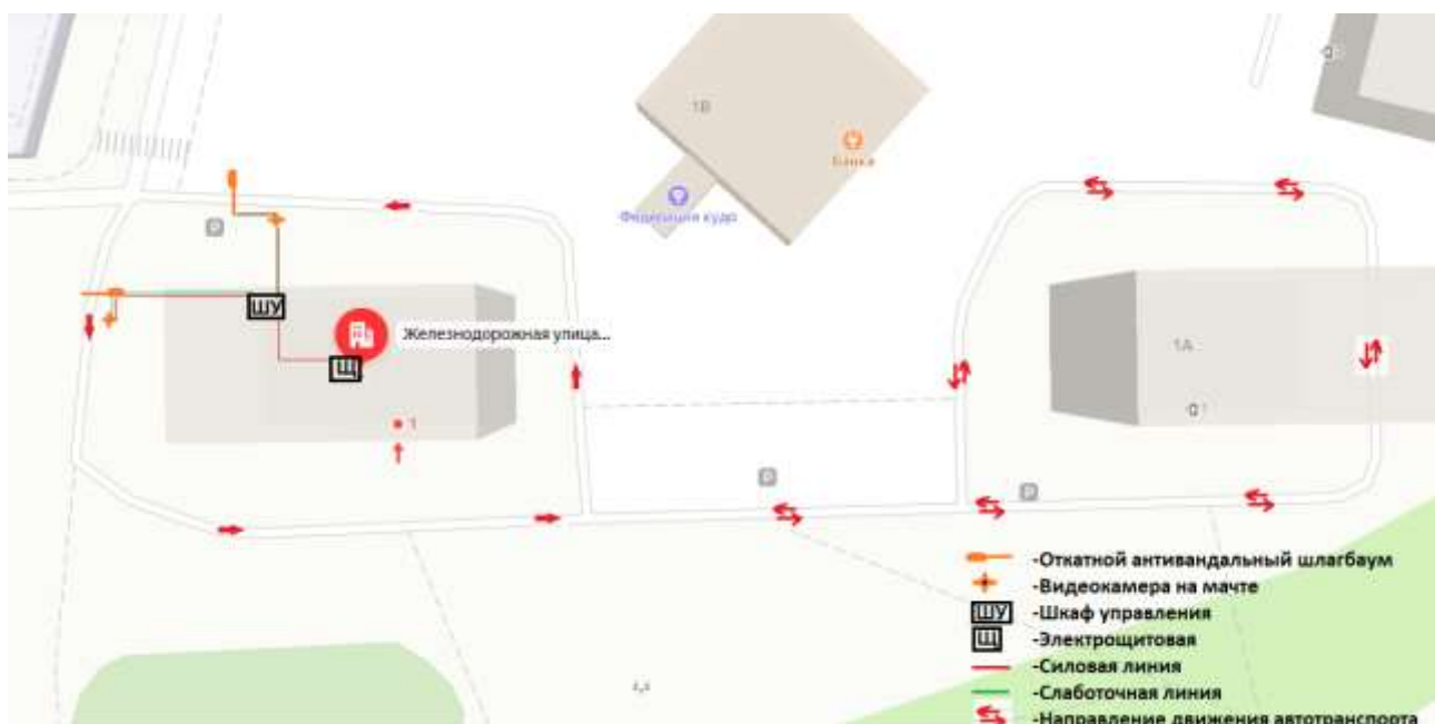
Рис. 1 Схема размещения шлагбаумов и прокладка кабельных коммуникаций
